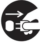
すぐに機器本体の電源スイッチを切り、電源プラグをコンセントから抜いてください。
