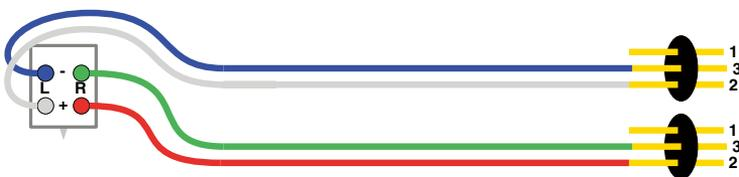
シールドがない場合でも、バランス接続できます。GND との接続は一切ありません。干渉によるノイズの発生がなければ、音質的に最も優れた結果が期待できます。この接続には、ツイストペアケーブルをご使用ください。CI(Current Injection) 入力は、容量性ノイズに対して敏感過ぎることは無く、また、コモンモードノイズに対する耐性に極めて優れています。CI 接続には、一般的に低誘導性のケーブルが適しています。
