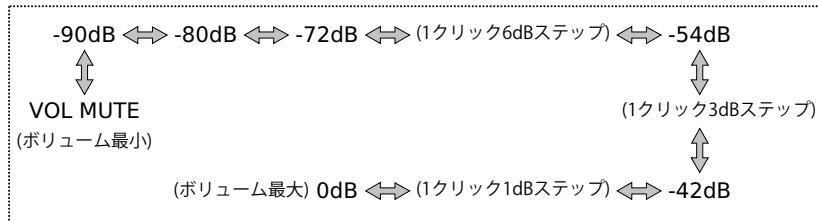
※本機のボリュームは、ヘッドフォン出力とVariable(可変)出力の両方に連動しています。使用しない機器の電源を切るかヘッドフォンプラグを外して使用することをおすすめします。
