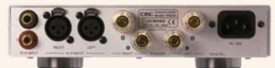
▲バランス端子とアンバランス端子を持つ入力系。極太スピーカーケーブルでも利用可能なように、保護プラスチックに覆われた大型な金メッキスピーカー接続端子を採用しました。RCA 端子は金メッキを施した音質重視タイプを採用しました。
