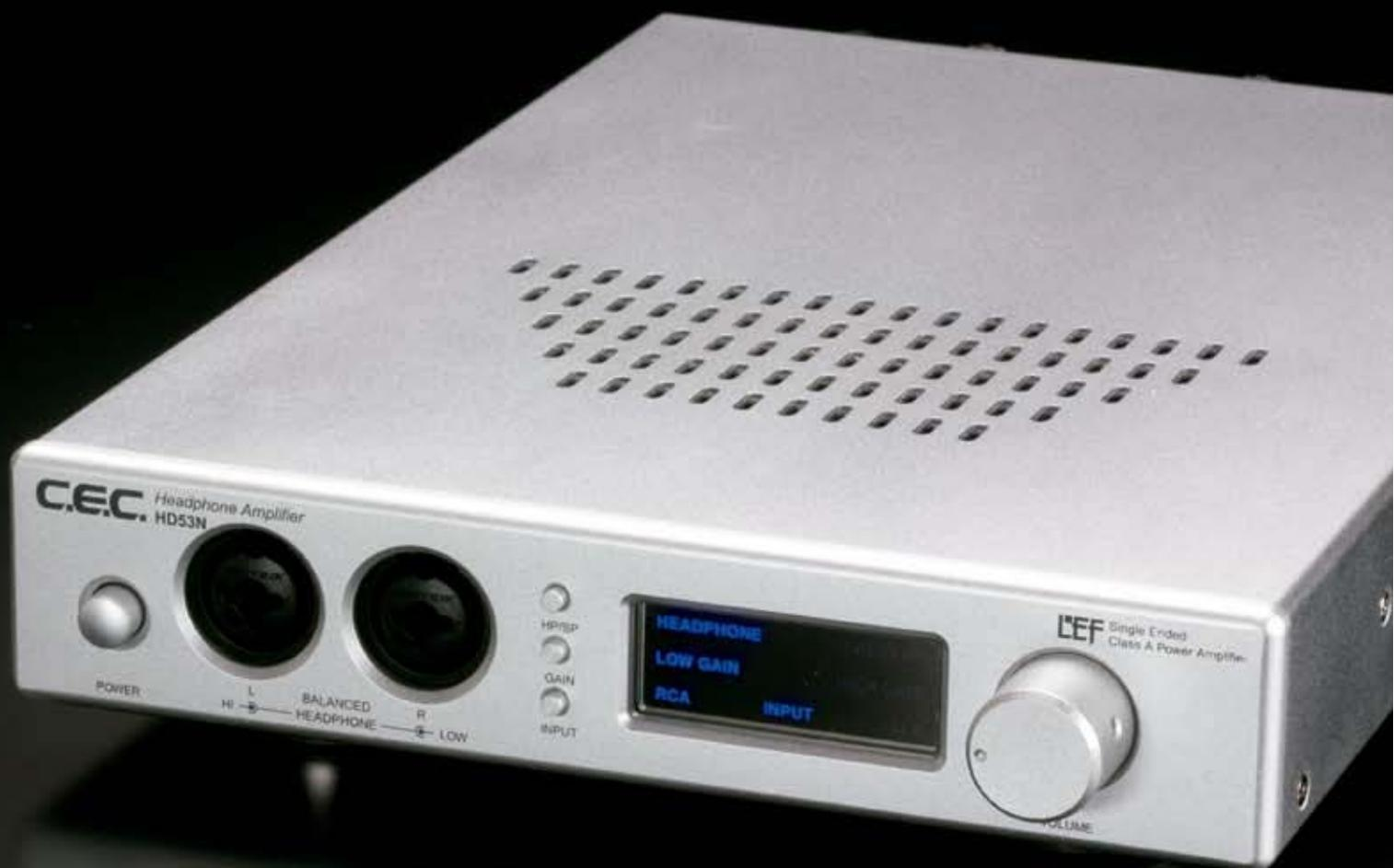
コンパクトでありながら、入力から出力まで完全バランス設計。プロ用高級ヘッドフォンに多いバランス型端子に対応した XLR 出力端子を備え、スピーカー出力にも対応したヘッドフォンアンプ
